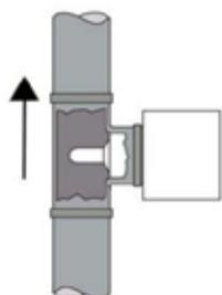
图四：当垂直安装时，应安装在由下至上流动的管段上。
