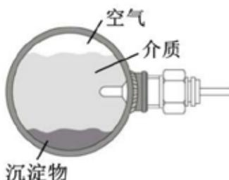
图五：当水平安装时，探头应避免空气和沉淀物。
